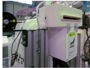
ペレタイザー・粉碎装置 (Strand cut pelletizer・Mill equipment)
