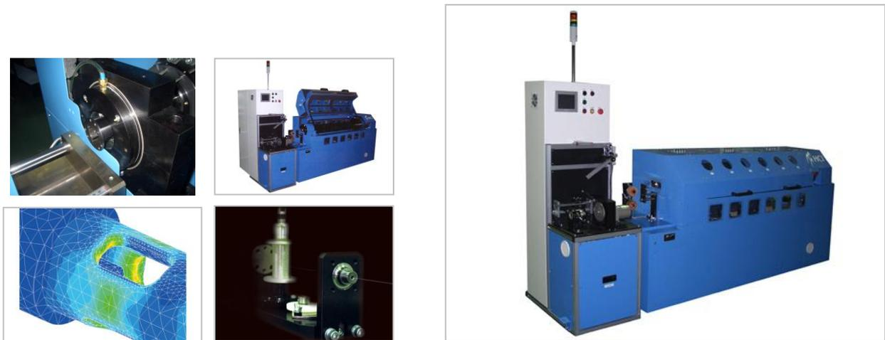
銅・銅合金線の極細線用チューブラー型撚線機で、主に AWG40 より細径化した AWG42 ~ AWG50 程度の撚線に用いられ、エレクトロニクス製品用及び、医療機器用の極細同軸ケーブル (MFCX) 等で使われております。
