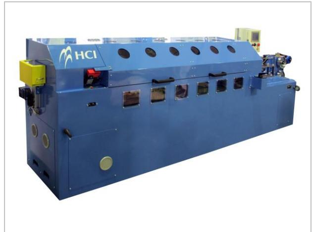
ステンレス線の極細線用チューブラー型撚線機で、 $\phi 9\mu\text{m}$ ～ $\phi 50\mu\text{m}$ 程度の素線径の撚線に用いられ、医療用ワイヤー等で使われております。
