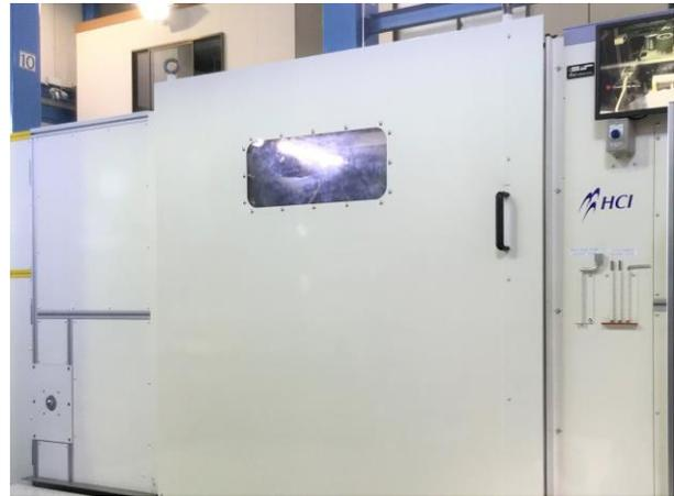
ダブルツイスト型は撚線機の中で最も高い生産能力を発揮し、コストパフォーマンスが最も高い特徴があります。しかし、デメリットとして使い易さでは最も劣ります。
