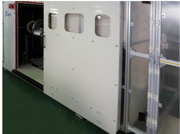
スキップ型は、チューブラー型と同等でチューブラー型よりもコストパフォーマンスを發揮した撚線機になります。被覆線の集合機用として、主にエレクトロニクス製品用及び、自動車用ケーブルや機器電線等で使われており、1Bでは2ヶ撚機として、大型になればトリプレックス等の電線の撚合用で使われております。
