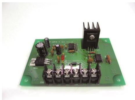
ケーブル・ワイヤー・チューブ・シート製造装置他、各種産業機械にて、電気式クラッチ・ブレーキ等を用いた張力制御用の DC アンプデバイスです。
